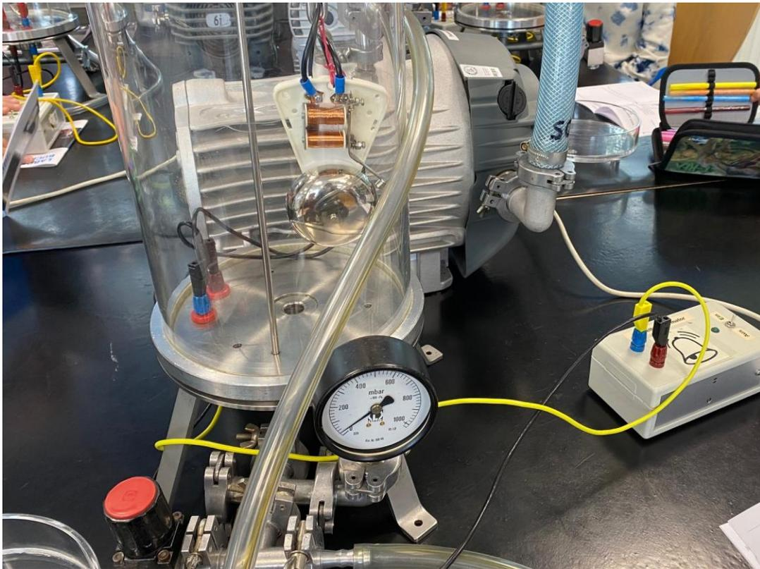
Jedes Zweierteam hatte einen eigenen Laborplatz mit einer Pumpe und einem Vakuumbehälter.
